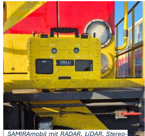
SAMIRAmobil mit RADAR, LiDAR, Stereo-Kamera, GNSS und 5G-Datenübertragung
